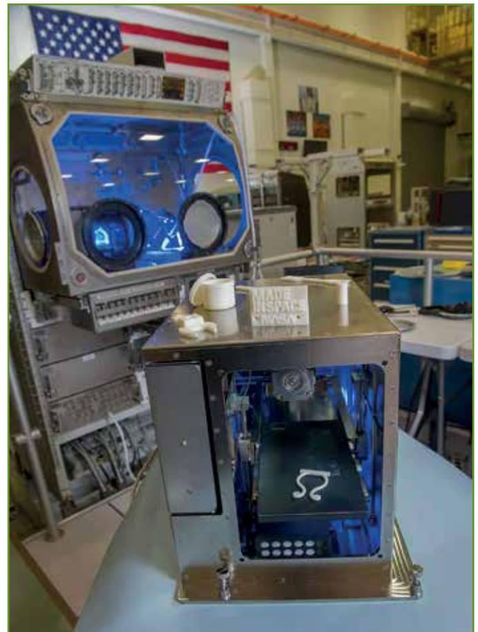
**Figura 1** • La stampante 3D della Stazione Spaziale Internazionale, con il primo oggetto stampato in 3D nello spazio. Foto: NASA.
