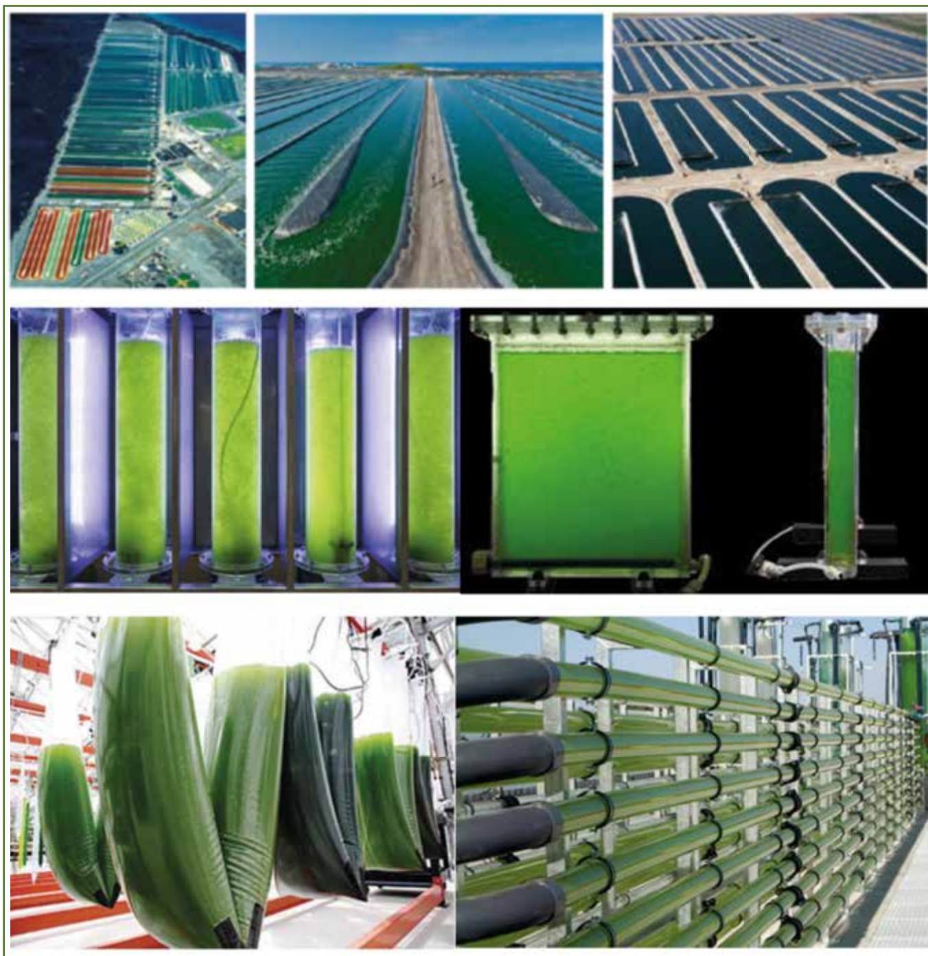
Figura 3 • Sistemi colturali a microalghe aperti (Open Raceway Pond) e chiusi (fotobioreattori). (Da: Benemann J. Microalgae for Biofuels and Animal Feeds. Energies . 2013; 6(11):5869-5886; Colucci P. La nuova generazione di fotobioreattori algali per la cattura della CO 2 . Authorea . 2021.)
