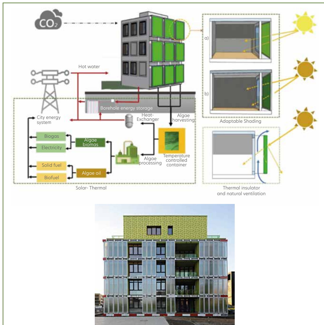
Figura 7 • Bio Intelligent Quotient (BIQ) building ad Amburgo, schema di ombreggiamento e riscaldamento e recupero energetico da biomasse algali nel BIQ. (Da Talaei M, Mahdavinjad M, Azari R. Thermal and energy performance of algae bioreactive façades: A review. J Build Engin. 2020;28:101011.)
