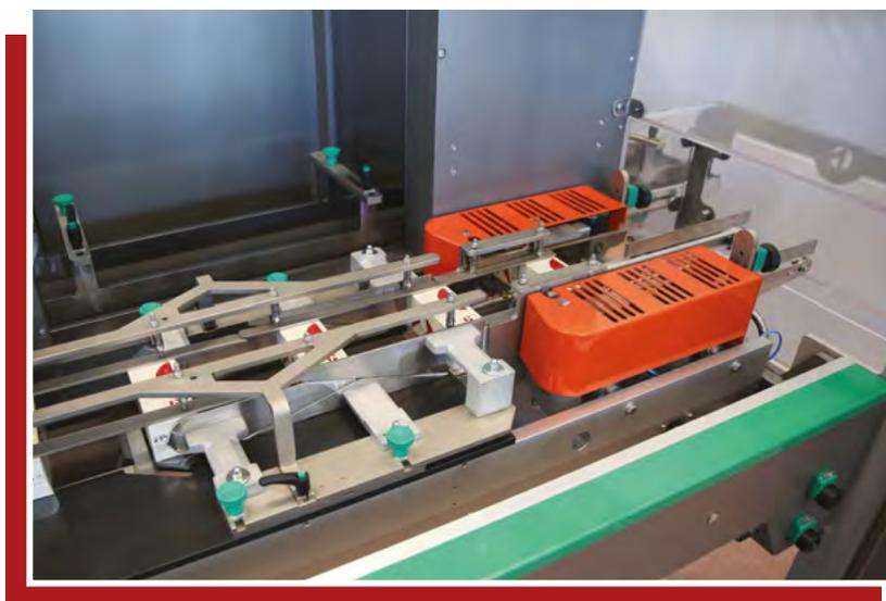
nuta laterali, che in versione ottimizzata per il packaging cosmetico, con piastre di tenuta che permettono di ottenere la chiusura a punto.
