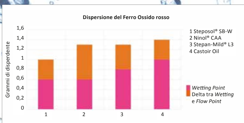
Figura 3 - Dati relativi alla capacità di disperdere ossido di ferro rosso (CI 77491)
