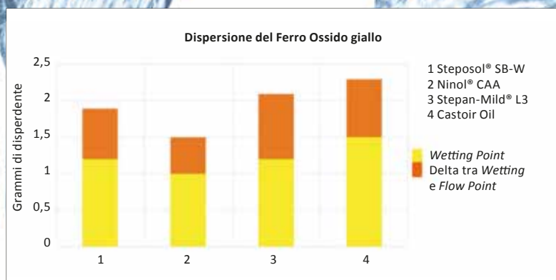
Figura 4 - Dati relativi alla capacità di disperdere ossido di ferro giallo (CI 77492)
