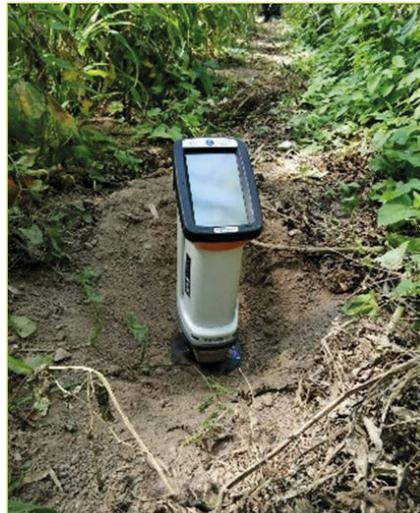
**Figura 6** • Analisi in sito tramite l'utilizzo di uno spettrometro a raggi X da campo di Geospectra.
