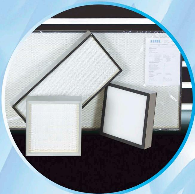
Questi filtri sono particolarmente progettati per l'utilizzo in camere bianche, cappe sterili, sale operatorie e industrie alimentari. Il pacco filtrante, del tipo a piccole pieghe con separatori in filo termoplastico, è sigillato in un telaio in alluminio estruso anodizzato.
