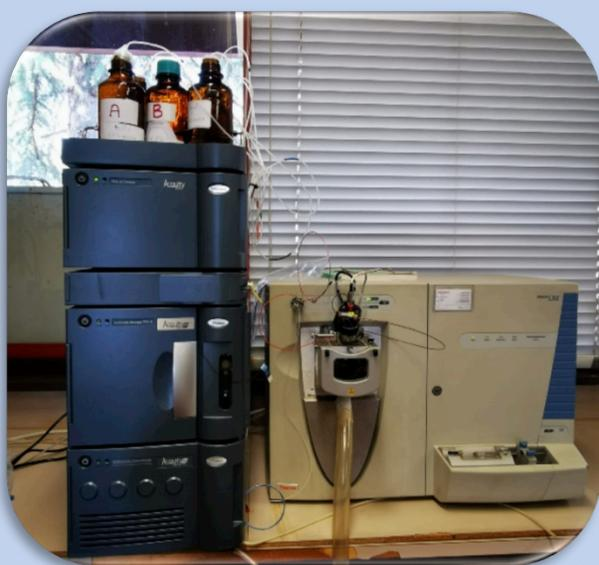
Gli stessi principi che separano le sostanze nella colonna di vetro vengono applicati in apparecchiature più sofisticate, in grado di lavorare anche su quantità molto piccole (**UHPLC**)
