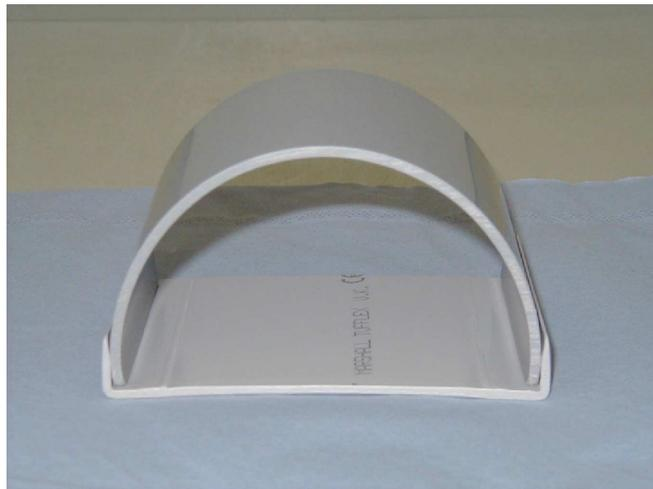
La base è progettata per contenere tutte le uova che non aderiscono alla superficie della piastrina e che ricadrebbero quindi sul fondo della vasca (o le uova depositate direttamente sulla base di plastica piatta). Tutti i substrati di riproduzione sono lisciviati per almeno 12 ore in acqua di diluizione prima dell'uso.
