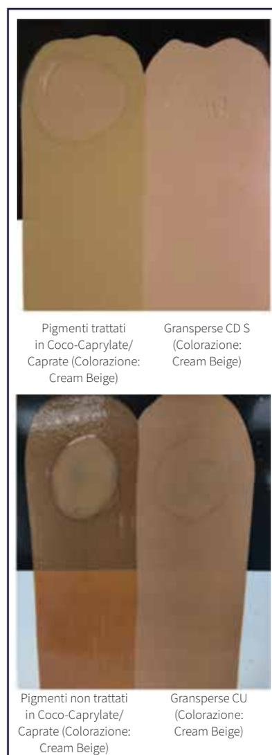
**Figura 3** - Test di uniformità di stesura ed espressione di colore
