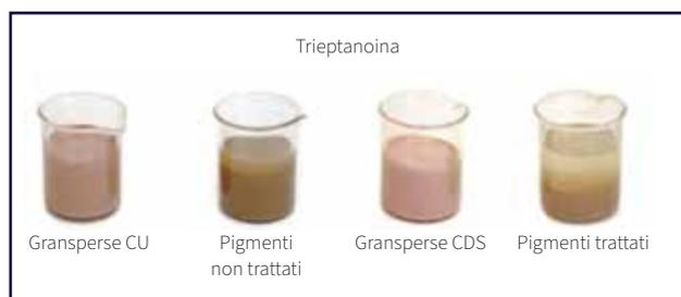
**Figura 4** - Test di compatibilità con trieptanoina
