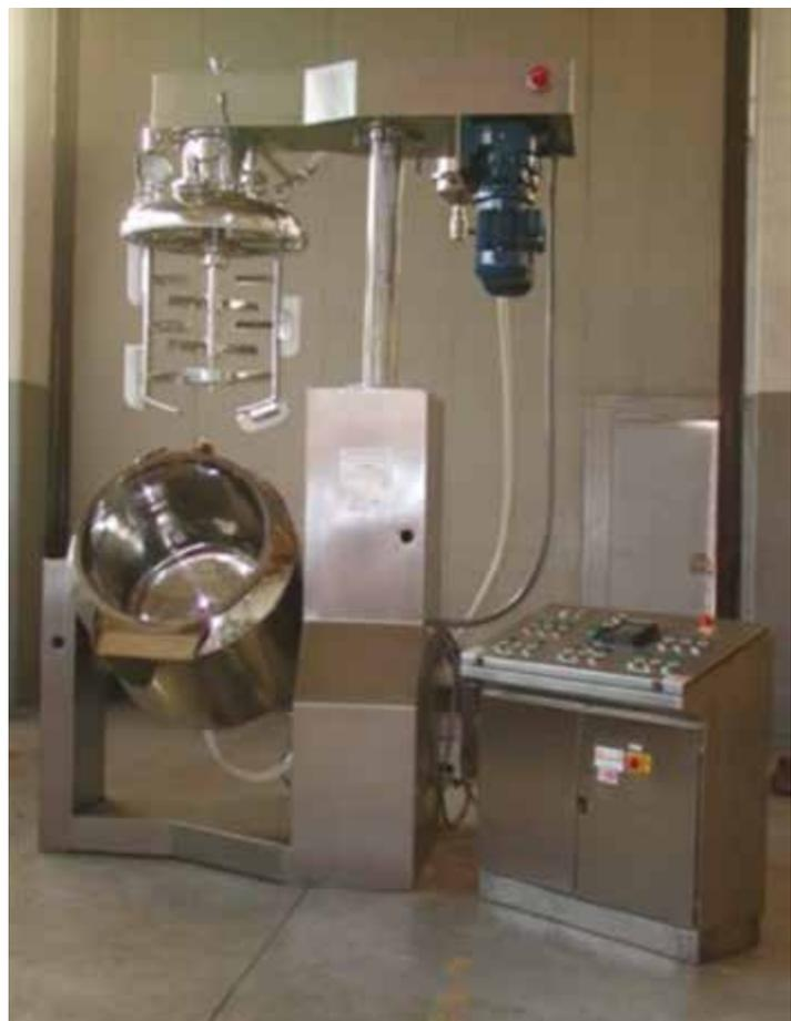
**Figura 3** - Turboemulsore BP2 da 250 kg
