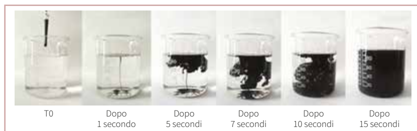
Figura 1 - Velocità di dispersione del BLACK OF 35 (0,05%) valutata su un periodo di 15 secondi
