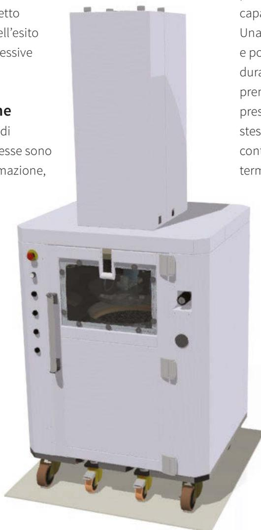
**Figura 4** - Serbatoio in pressione: il piatto premente di IDM Automation utilizzato per l'alimentazione a freddo del bulk verso il sistema volumetrico di dosatura
