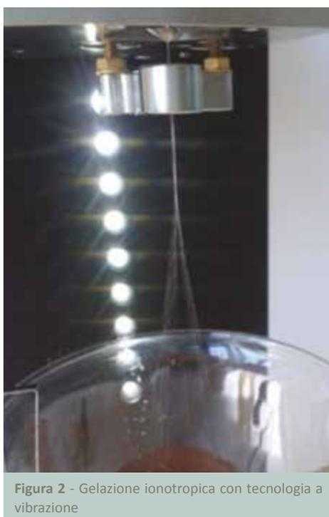
Figura 2 - Gelazione ionotropica con tecnologia a vibrazione
